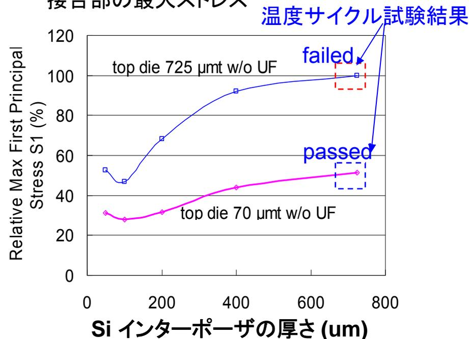
温度サイクル試験 有機基板上の3層積層接合部のストレスの有限要素法シミュレーションを行った
