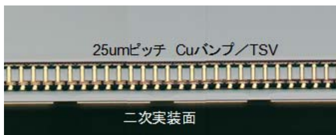
完成したデバイス付き3層積層ウェハとその断面写真
